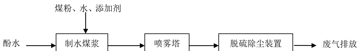
图 2.2-8 含酚废水处理工艺
