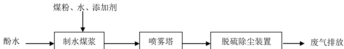
图 2.2-5 含酚废水处理工艺
